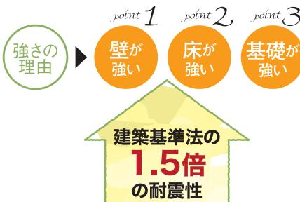
「耐震等級3」は、国土交通省が2000年に定めた、住宅性能表示制度における耐震性能の最高等級です。建築基準法では、極めてまれに(数百年に一度程度)発生する地震による力が定められており、この力に対して倒壊しない程度のものを「等級1」としています。
